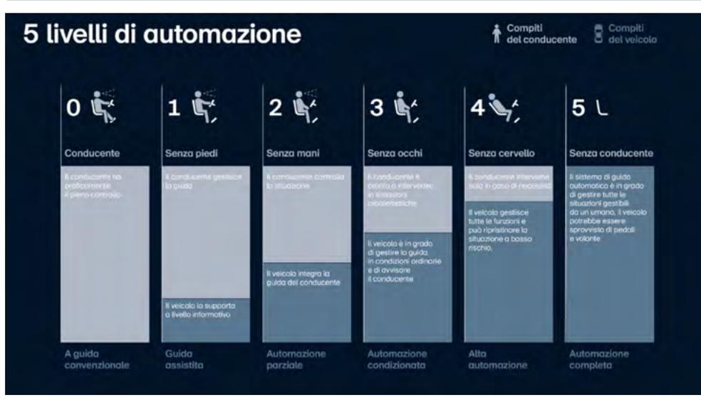
Nel livello **SAE 0** non è attivo alcun sistema automatico e il conducente è responsabile della guida, dell'accelerazione e della frenata della vettura.
